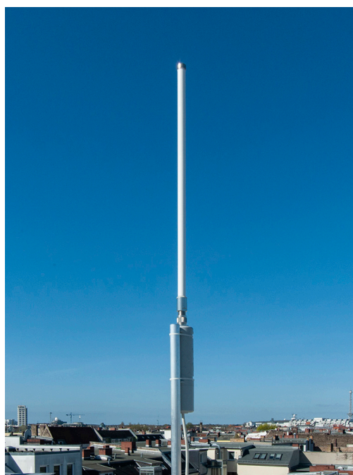
Antena exterior LoRaWAN con alcance de hasta 15 km
