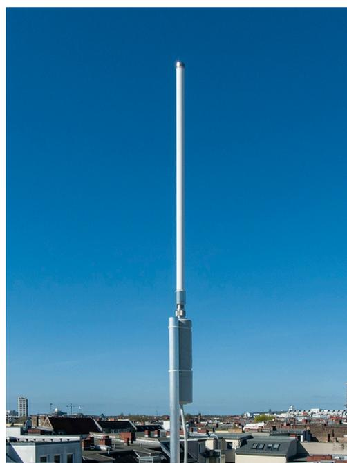
LoRaWAN-Outdoor-Antenne mit bis zu 15 km Reichweite
